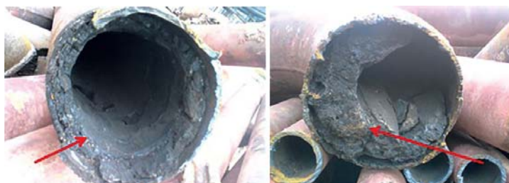
Hình 8. Ảnh minh họa lớp bám bẩn bên trong ống truyền nhiệt
