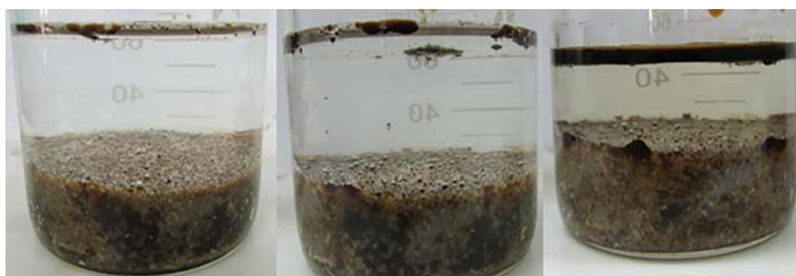
Hình 15. Khảo sát khả năng tự đẩy dầu của hệ hóa phẩm phối trộn theo thời gian
